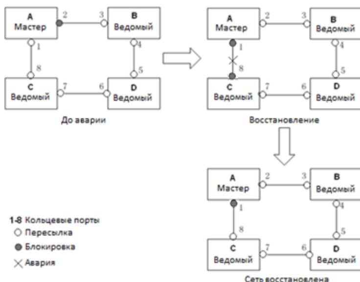
Рис. 205. Диаграмма восстановления сети между коммутаторами А и С
