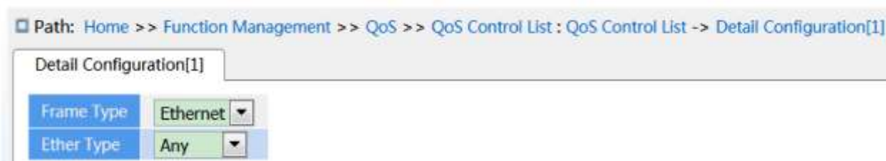
Рисунок 287 – Настройка параметров EtherType
