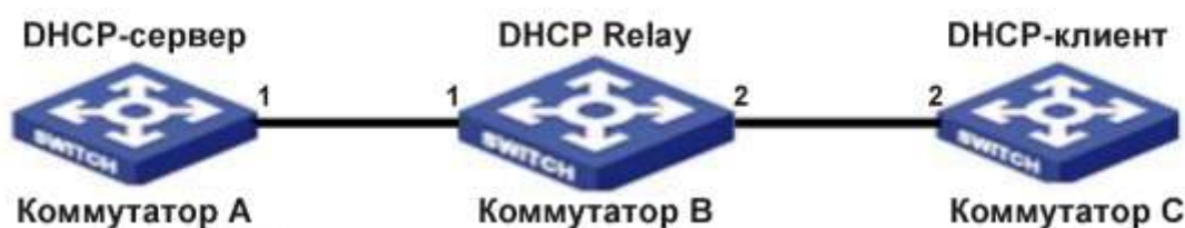
Рисунок 320 – Конфигурация DHCP с ретранслятором
