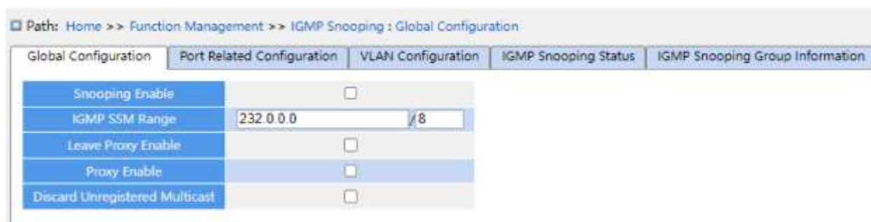
Рисунок 192 – Глобальная настройка IGMP Snooping
