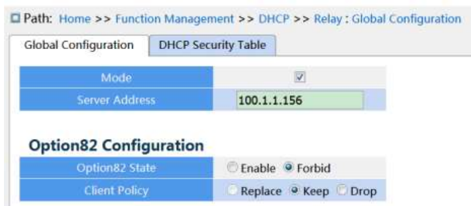
Рисунок 215 – Глобальная настройка DHCP Relay
