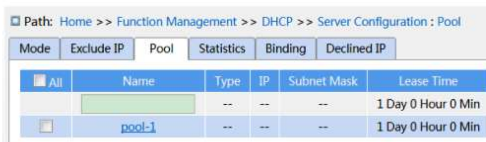
Рисунок 201 – Создание адресного пула
