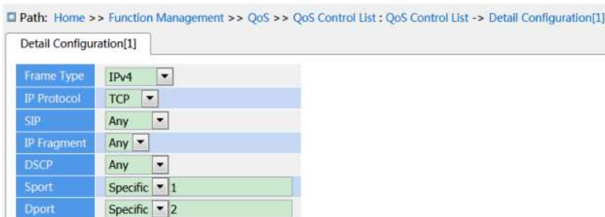
Рисунок 290 – Настройка параметров IPv4
