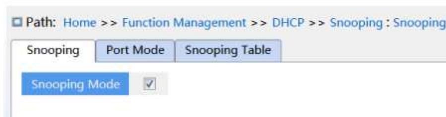
Рисунок 210 – Включение DHCP Snooping
