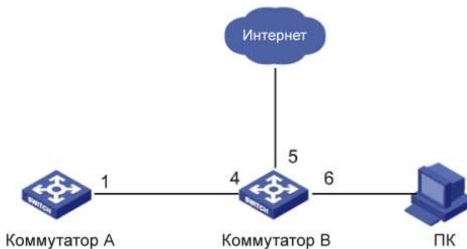
Рисунок 115 – Схема подключения устройств GVRP
