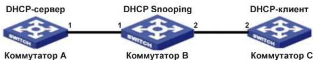
Рисунок 321 – Конфигурация DHCP с функцией Snooping
