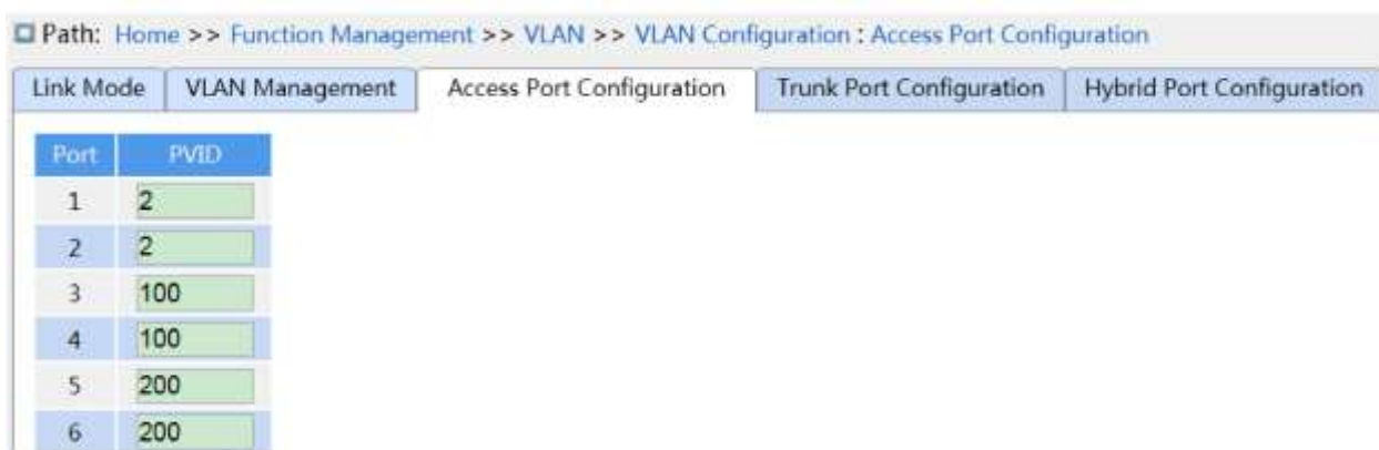
Рисунок 109 – Настройка порта доступа
