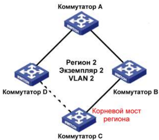
Рисунок 159 – Привязка VLAN 2 к экземпляру 2
