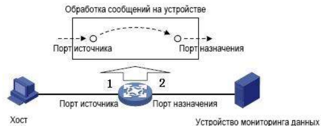
Рисунок 308 – Пример зеркалирования портов
