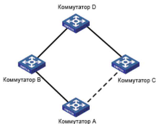
Рисунок 29-1 – Сеть с резервным каналом
