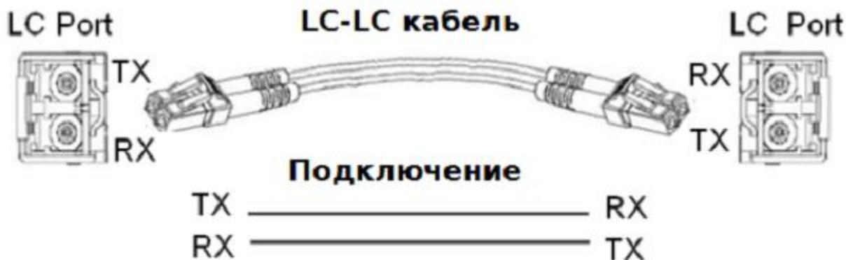
Рис. Подключение оптического кабеля
