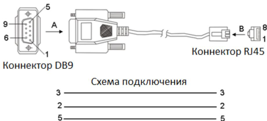
Рис. 18. Схема подключения консольного кабеля
