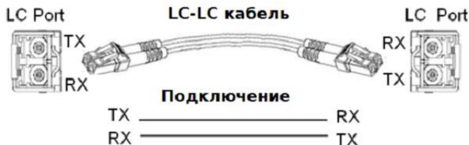
Рис. 15. Подключение оптического кабеля
