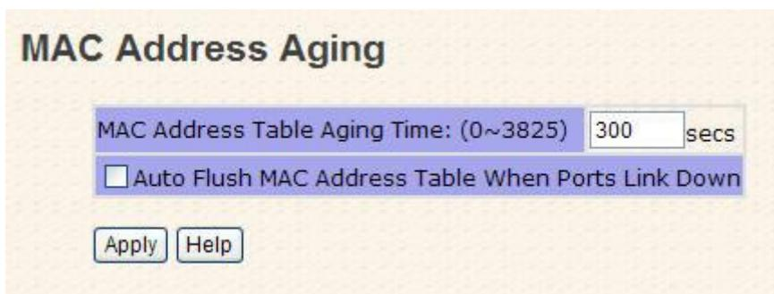
Рис. Интерфейс MAC Address Aging
