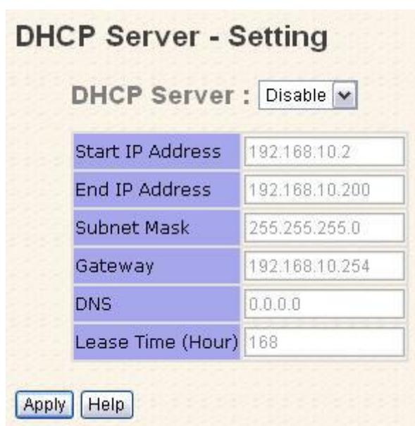
Рис. Интерфейс конфигурирования DHCP сервера
