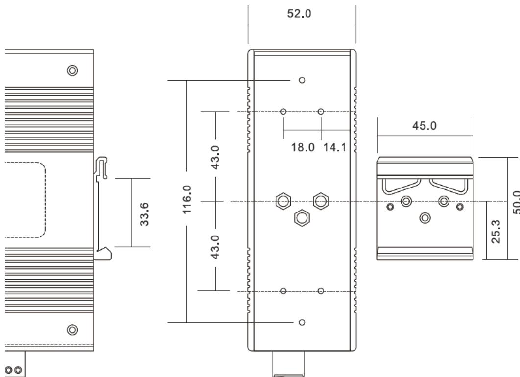
Рис.1 Размер крепления на DIN-рейку
