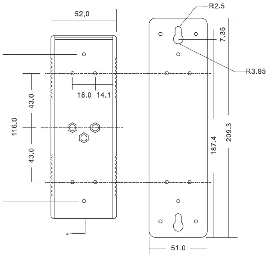
Рис.2 Размер настенного крепления
