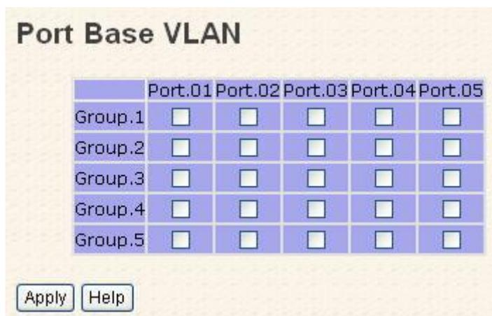
Рис. Интерфейс настройки VLAN на основе портов
