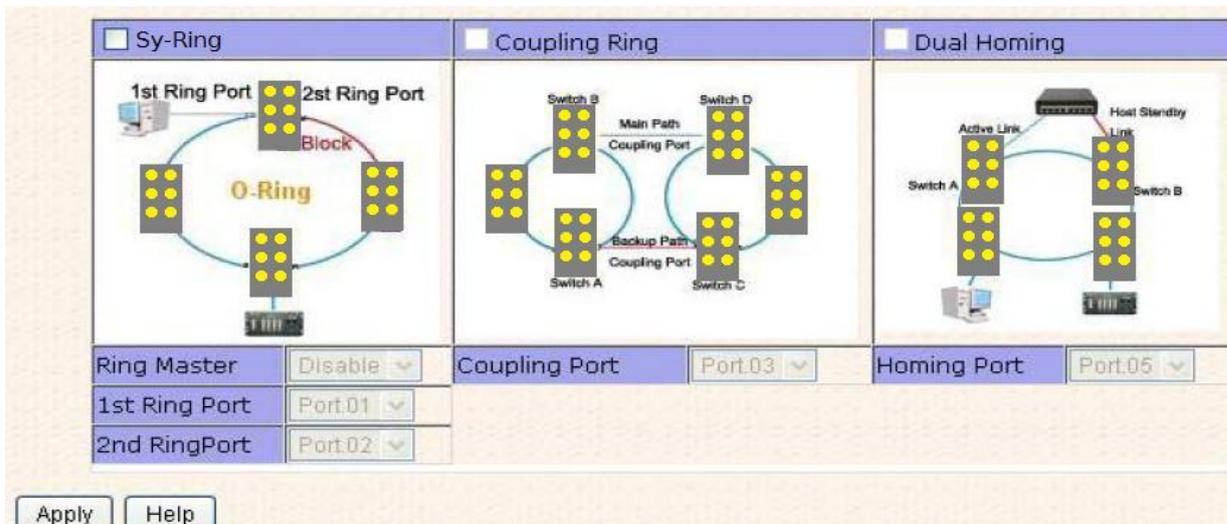
Рис. Интерфейс Sy-Ring
