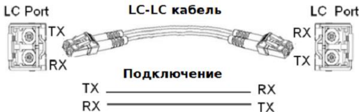
Рис. Подключение оптического кабеля
