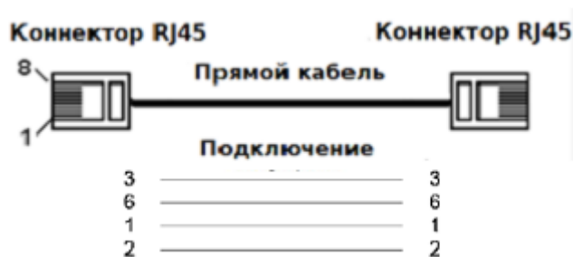
Рис. Подключения прямого кабеля
