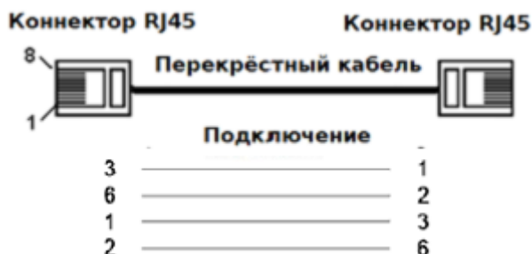
Рис. Подключения перекрёстного кабеля
