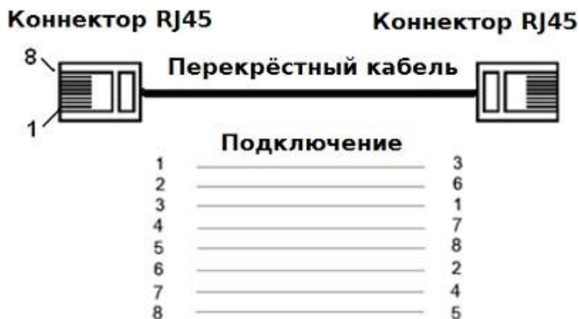
Подключения перекрёстного кабеля
