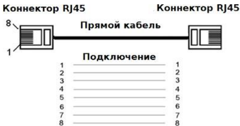
Подключения прямого кабеля
