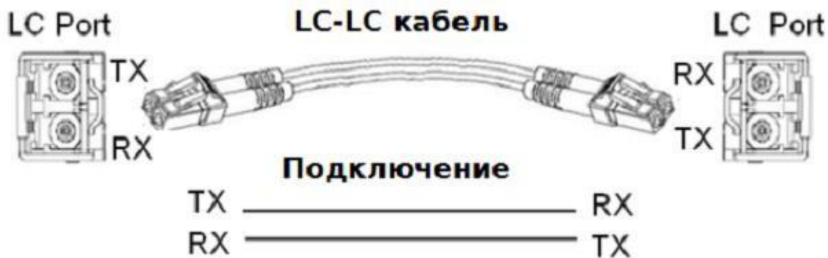
Подключение оптического кабеля
