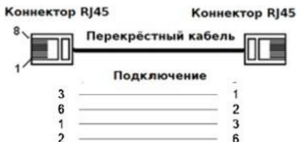
Подключения перекрёстного кабеля
