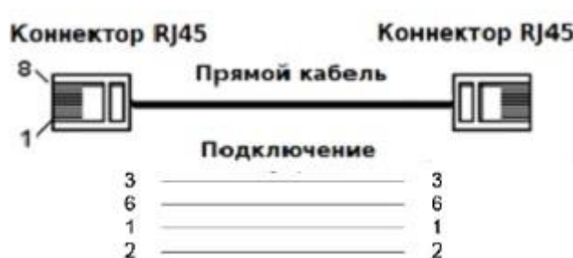
Подключения прямого кабеля
