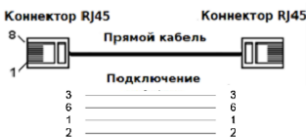
Рис. Подключения прямого кабеля
