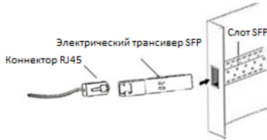
Рис.26. Подключение электрического трансивера SFP
