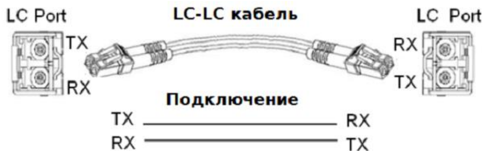
Рис. 23. Подключение оптического кабеля к оптическому трансиверу
