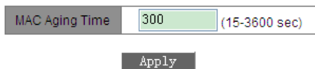
Рисунок 113 – Настройка времени устаревания MAC-адресов
