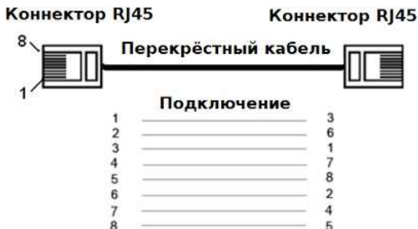
Подключения перекрёстного кабеля
