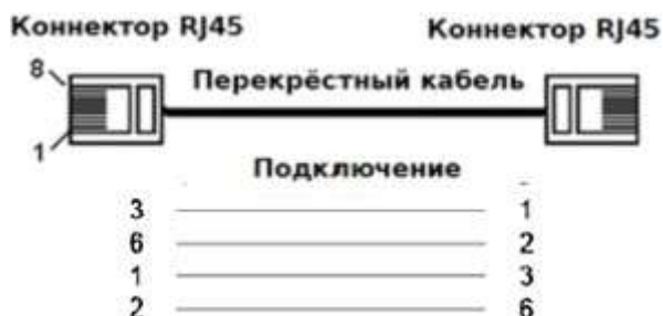
Подключения перекрёстного кабеля
