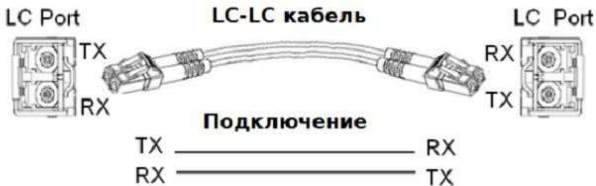
Подключение оптического кабеля
