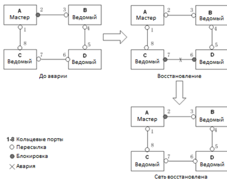
Рис. 204. Диаграмма восстановления сети между коммутаторами С и D
