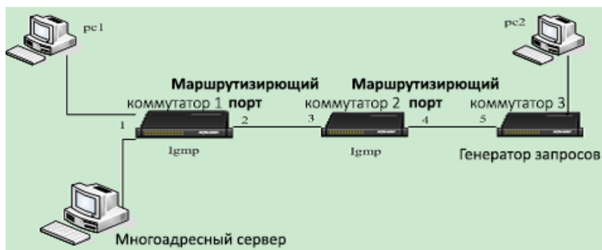
Рис. 87. Пример типовой настройки IGMP Snooping
