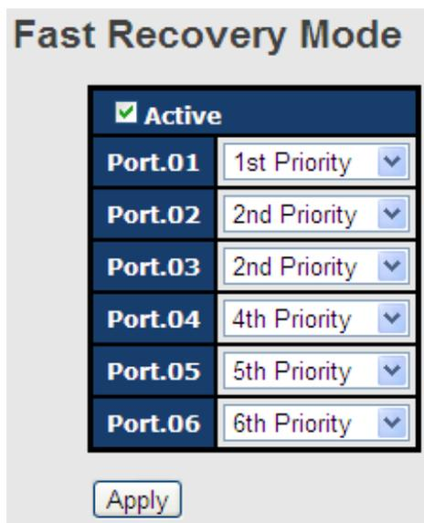
Рис. Интерфейс режима быстрого восстановления
