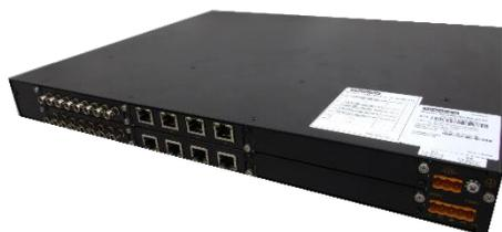
Благодаря прочному металлическому корпусу и охлаждению без применения вентиляторов, коммутаторы серии SEWM2 позволяют возводить надёжные магистрали в условиях ЭМИ, вибраций и других неблагоприятных условий.
